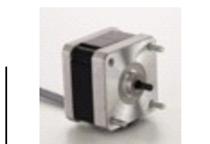
18303773 Moteur pas a pas hybride 2 phases 4fil 35*35*25mm, 1.8° 25V /// EM527
