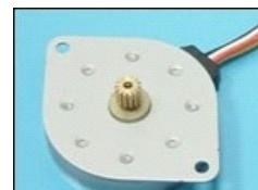
18303774 Moteur pas a pas 4 fil 2.1R OD:42mm*th24mm ,3.75°, 12 V, 4 Ohm /// 2T423589
