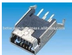
18910012 Fiche MINI USB/5pin parallele femelle 180° angle chassis SMT connection /// MU-5F-22
