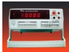
23404303 MULTIMÈTRE DE BANC 20.000point , 'AC/DC (jusqu'à 1000V, à AC750V/ 10A/resist 20 Mohm, frequence 200KHZ, avec Protection de
