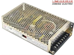
24207046 Alimentation à découpage 110-220VAC \pm 15\% 250W 24V 10A /// HS-250-24
