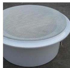
22804905 HP a caisson plafonier 15w, HP 200mm imp: 670/1k/2kR/ 8R transfo de ligne 100V freq: 90- /// TSCL-15WA
